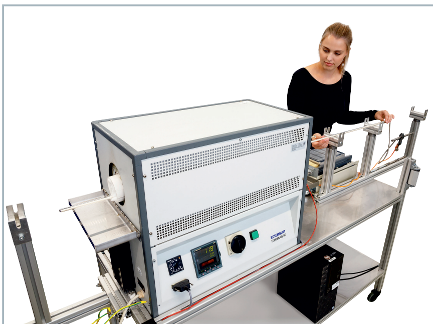
Bild 1. Die zweiwöchige Kalibrierung von Multipoints wird in einem speziellen Rohrofen durchgeführt.
